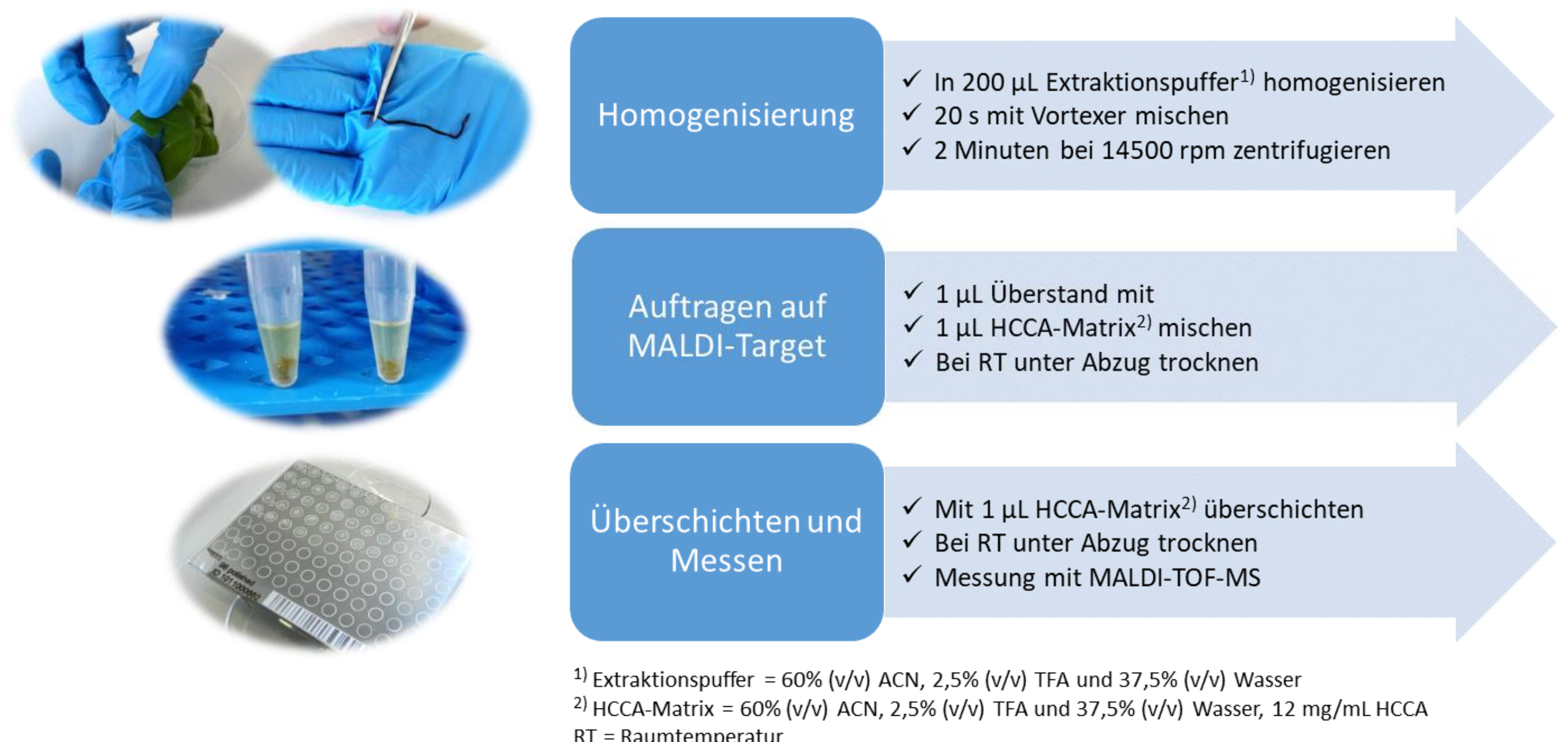
Abb. 2: Optimiertes Protokoll für die Probenvorbereitung von weichen Pflanzenteilen
